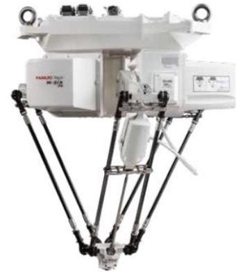
Pour ce projet, notre choix porte sur le robot 4 axes M-2 iA 3S. En effet, il n'est pas nécessaire d'avoir une rotation autour du poignet.
